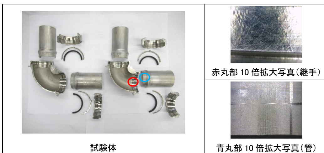
写真 4-8-2 腐食試験結果
