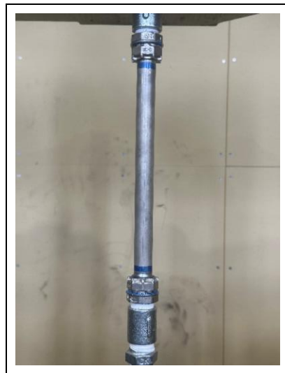
写真 4-20 内圧繰り返し試験後の引抜試験状態
