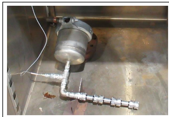
写真 4-9 実体による促進劣化試験状態
