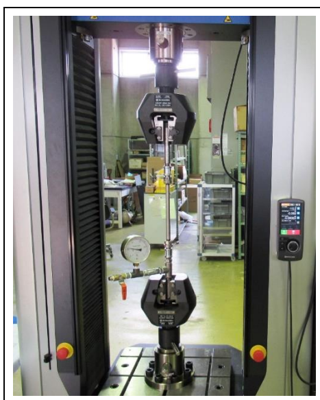
写真 4-4 引抜試験状態
