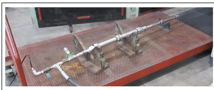
写真 4-6 内圧繰り返し試験状態
