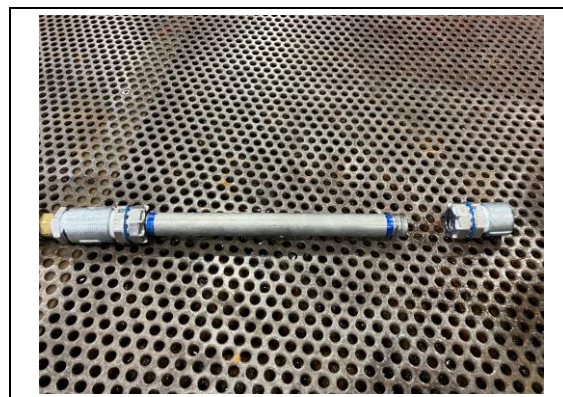
写真 4-19 内圧繰り返し試験後の破壊水圧試験状態
