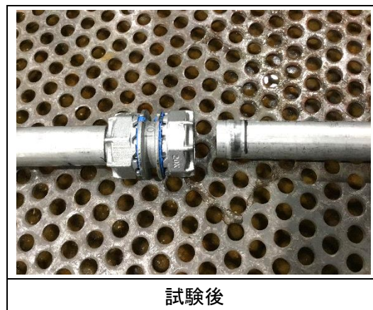
写真 4-12 破壊水圧試験状態
