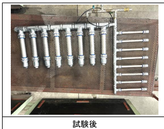
写真 4-18 内圧繰り返し試験状態
