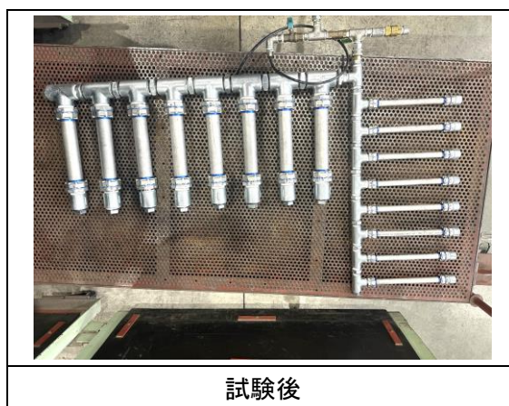
写真 4-19 内圧繰り返し試験状態
