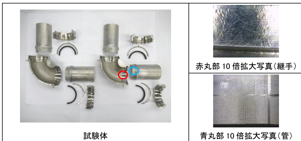
写真 4-8-2 腐食試験結果
