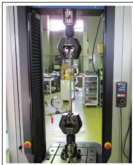
写真 4-4 引抜試験状態
