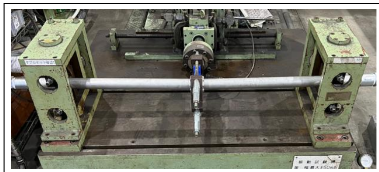
写真 4-21-1 耐震試験(震度 7 相当、加速度 947Gal)状態
