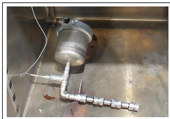
写真 4-9 実体による促進劣化試験状態
