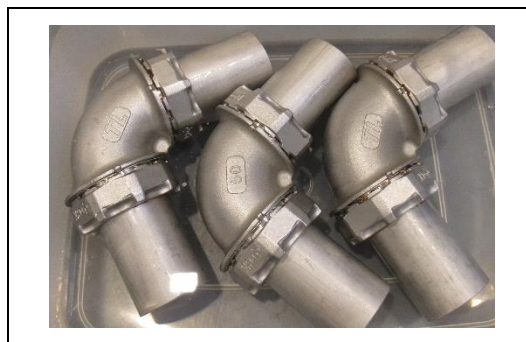
写真 4-8-1 腐食試験状態
